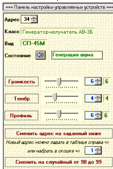
Рисунок 4. Панель настройки сохраняемых параметров: адреса, громкости, тембра и профиля
